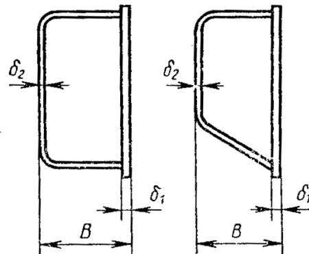
Борт с прямым формообразующим элементом и составным коробом
