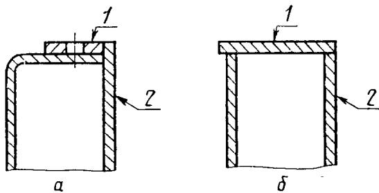
1 - опорная поверхность; 2 - формообразующая поверхность
