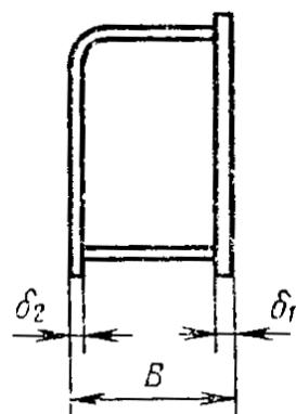
Борт с формообразующим элементом сложной конфигурации
