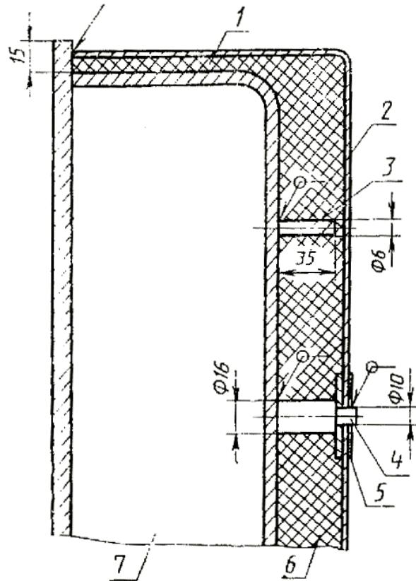
1 - минеральная вата; 2 - кожух; 3 - штырь; 4 - упор; 5 -шайба; 6 - теплоизоляционные плиты; 7- паровая полость
