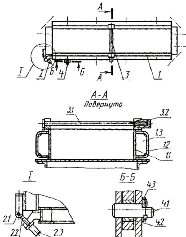
1 - борт: 1.1 - формообразующий элемент, 1.2 - короб, 1.3 - ребро жесткости; 2 - замковое устройство: 2.1 - ось, 2.2 - болт, 2.3 - гайка; 3 - стяжка: 3.1 - болт, 3.2 - гайка; 4 - шарнирное устройство: 4.1 - ось, 4.2 - втулка, 4.3 - шайба
