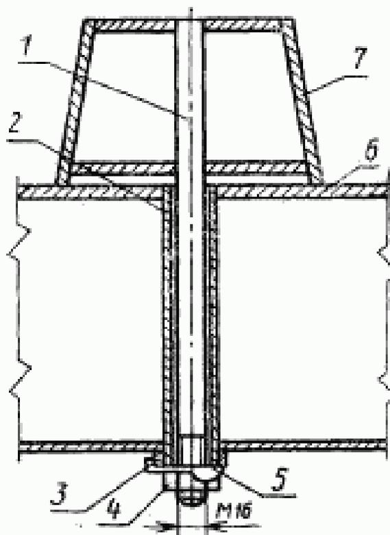
1 — шпилька; 2 — направляющая; 3 — плетка; 4 — гайка; 5 — отгибная шайба; 6 — поддон; 7 — вкладыш
