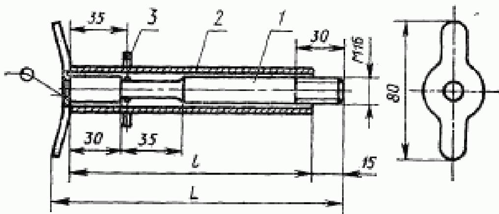
1 — фиксатор; 2 — труба; 3 — скоба
