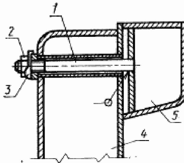
1 — шпилька; 2 — гайка; 3 — отгибная шайба; 4 — борт; 5 — вкладыш
