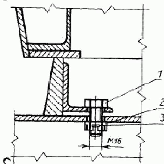
1 — болт; 2 — гайка; 3 — шпилька
